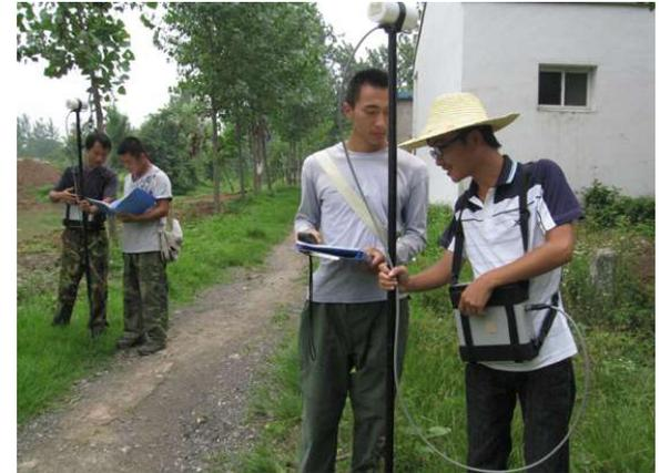
当在**近于垂直地磁场T**的方向施加约50**奥斯特**的人工磁场时，由于这一磁场远远大于地磁场，则原来沿地磁场方向的质子自旋轴都转至磁化磁场方向。
