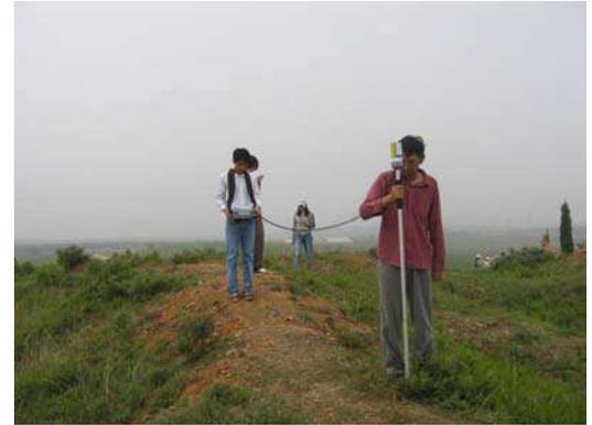
(4) 观测时应保证**点位正确**，同时每次观测时**探头的高度均应保持一致**；观测时如遇有事故（如仪器受震），仪器性能可能发生突然变化时，应即回到震前测过的几个测点（点位要正确）上作重复观测，必要时应加到**校正点上**作重复观测，以检查仪器性能，当确认仪器性能正常后，方可继续观测；
