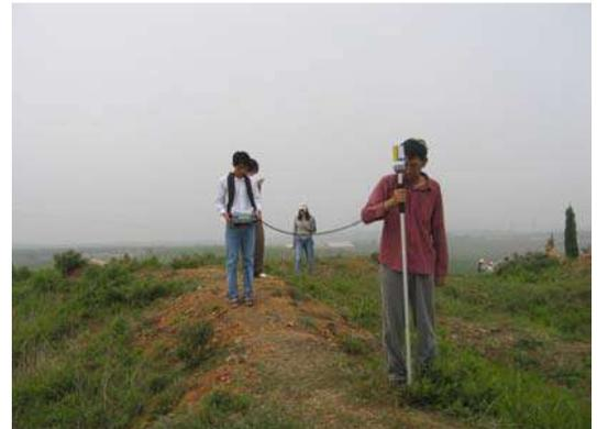
(5) 当观测结果出现如下变化时必须采取的相应措施：a. 当相邻两测点读数相差较大时，或当有值得注意的地质现象时，须加观测点；b. 当相邻测线的异常特征明显不一致时，须加测线；c. 当测区边缘发现可能有意义的异常或值得注意的地质现象时，须追踪观测；d. 随时注意异常与周围地质现象之间的关系，记于备注栏内，必要时需试测岩石磁性或采集标本；e. 遇有磁性干扰物（如铁路、厂房、井场、高压线、有磁性的岩坎或岩石堆等）时，须合理移动点位，避开干扰，并加注记以备日后核查。
